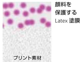
プリンターから出力された時点で乾燥・硬化しており、後加工、梱包、施工がすぐに行えます。成果物をすぐにラミネート加工することができ、生産性が向上します。この画像形成プロセスを用い、HP Latex インクはエコソルベントインクと同等の高い品質と耐候性を持つプリントを作成することができます。
