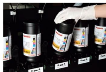
ご購入頂いた1Lインクボトルは、インク供給ユニットにそのまま差し込んでお使い頂けます。インクボトルは、本体の前面で簡単にセットできます。
