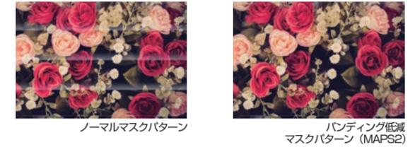
バンディングを効果的に抑制する「MAPS2」(\*)を搭載。ドットの密度をコントロールし、グラデーションの様に階調を持たせることによって、バンディングを軽減します。ノーマルマスクパターンもご用意しておりますので用途や材質に応じて使い分けが可能です。
