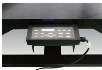
プリンタの操作パネルを本体の前後に設けました。後部にも操作パネルを設けることにより、本体を操作するために毎回移動する手間がなくなり、作業効率が向上します。
