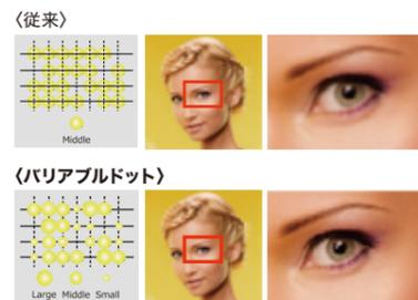
最小4plのドットを含む組み合わせで、粒状感の少ない滑らかなカラー印刷が可能。
