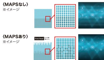
メディア種・インク種・解像度等の印刷条件に合わせて、自動で最適なグラデーションパターンを選択し印刷をします。
